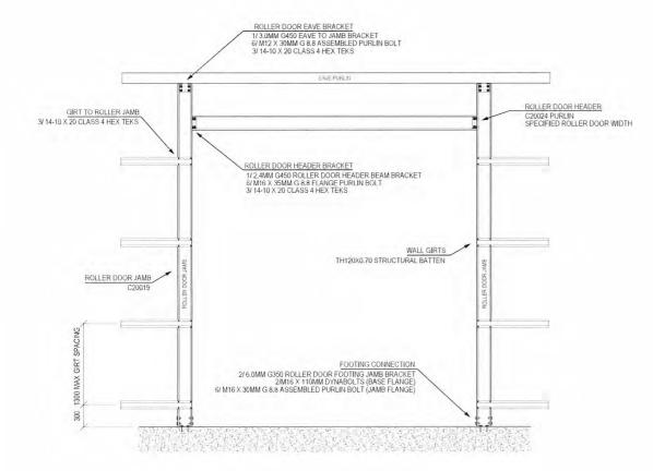
EAVE PURLIN ROLLER TO EAVE BRACKET ROLLER DOOR HEADER BRACKET ROLLER DOOR JAMB ROLLER HEADER WALL GIRTS ROLLER JAMB FOOTING
